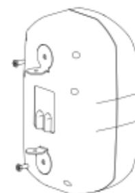
**3** Retire la cubierta impermeable. Conecte el cable del altavoz a el terminal ("+" a "+", "-" a "-")
