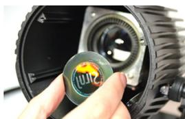
2. Desenrosque el anillo y gire la parte delantera para ajustar el tamaño de la imagen. Después de ver la imagen nítida, enrosque el anillo para fijar la posición.
