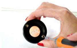
3. Desenrosque los tornillos del porta gobos mediante un destornillador de estrella.
