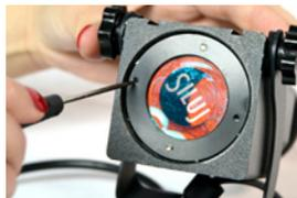
4. Coloque el porta gobos en la rosca del cuerpo de proyector y mediante el destornillador girelo hasta colocarlo en la posición inicial.
