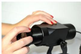
1. Desenrosque la pieza disipadora de calor hasta el final de la rosca.
