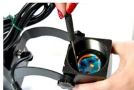
Cuando el porta gobos llegue a su posición inicial asegúrelo mediante el tornillo allen situado en el cuerpo del proyector, para eso utilice la llave allen suministrada.
