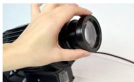
2. Desenrosque el anillo y gire la parte delantera para ajustar el tamaño de la imagen. Después de ver la imagen nítida, enrosque el anillo para fijar la posición.
