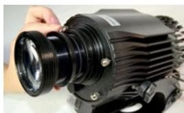
1. Fija la lente en el proyector, (la imagen se puede ver un poco borrosa) ajuste el tamaño y definición de la imagen.
