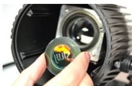
2. Desenrosque el anillo y gire la parte delantera para ajustar el tamaño de la imagen. Después de ver la imagen nítida, enrosque el anillo para fijar la posición.
