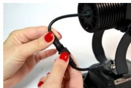
Conecte de nuevo el conector que une el cuerpo de proyector con la base.
