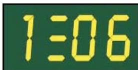
Canal 1 fijado a 6% de precalentamiento
