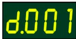
PASO 2: Presionar el botón **FUNC** y el display se coloca como abajo
